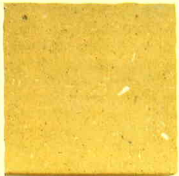
硬化遅延剤による仕上げ
